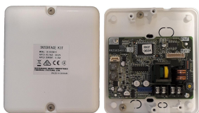
Interface koppeling SC-BIKN2-E t.b.v. bedrade bediening RAC-units
